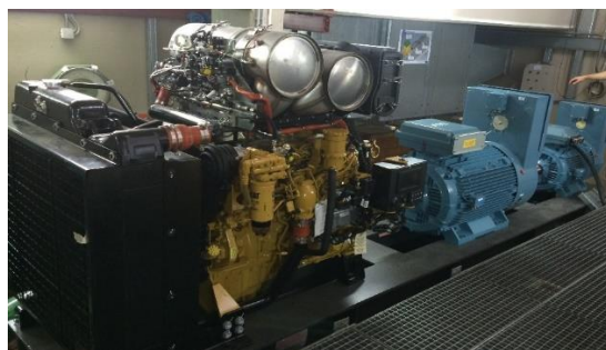
Υβριδική ντιζελο-ηλεκτρική εγκατάσταση πρόωσης
