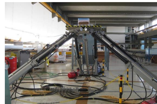
Τράπεζα ταλαντώσεων με δυνατότητα κινήσεων σε 6 βαθμούς ελευθερίας
