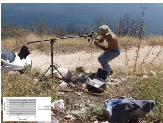
Συλλογή στοιχείων υπαίθρου με τη χρήση φασματοραδιόμετρου
