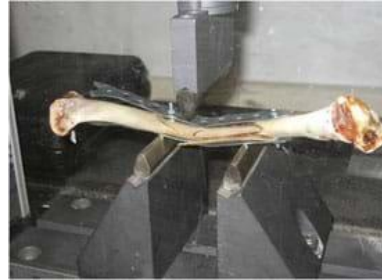
Πειραματική διάταξη για την αντοχή οστού
